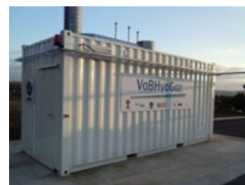
Unité pilote de 10 kg/j d'Hydrogène
